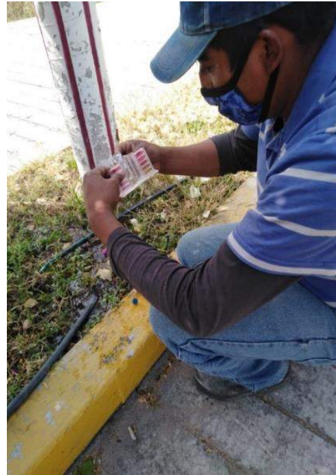
Verificación de cloración en el Barrio San Vicente.
